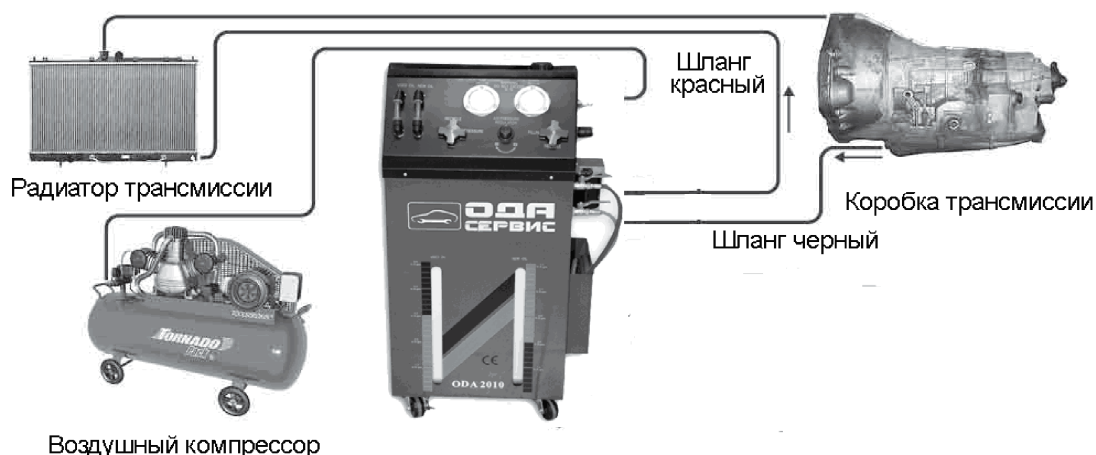
Рис. 5 – Схема процесса замены масла
