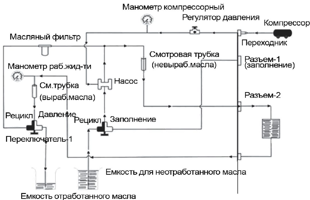
Рисунок 7 – Общая схема цикла очистки
